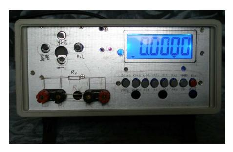
特点:本数字电桥又称数字欧姆计,用于测量直流电阻,适应测量金属体,导线电阻(小型马达、小型变压器、继电器)等。本测量精度高、便于携带、操作方便抗干扰能力好,具有六档量程功能,适合实验室和现场测量。
