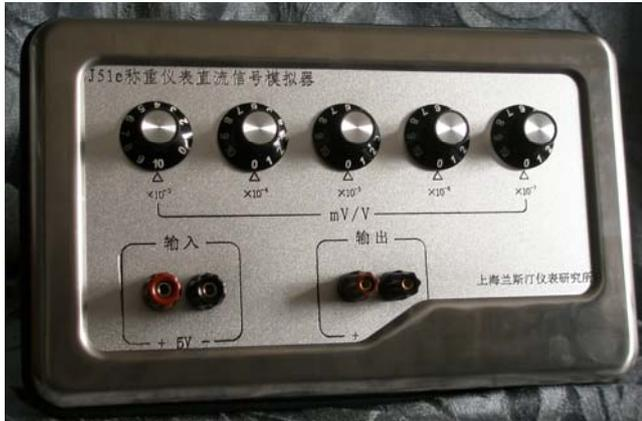
UJ51e 称重仪表直流信号模拟器, 是用于模拟称重传感器电信号的一种装置。具有线性度极高、稳定性好的特点, 广泛用于称重二次仪表的检测与调试。
